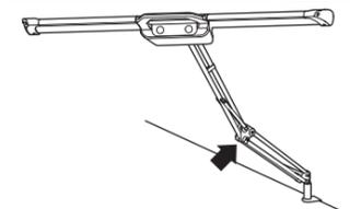
アームが左図のように逆方向に曲がった場合は、無理に可動操作せずに上アームと下アームの中間部分に手を添えて矢印の方向に軽く押しあげて定常姿勢に戻してください。
