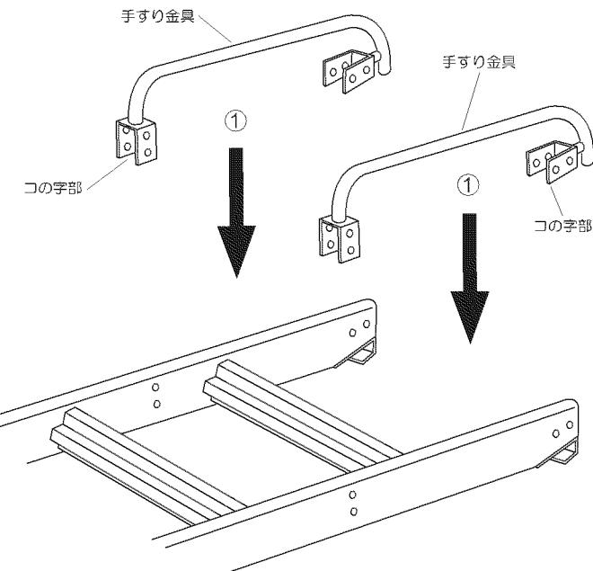
②手すり金具のコの字部分の穴と、支柱の穴の位置を合わせ、その穴に内側からナット8個を差し込んでください。
