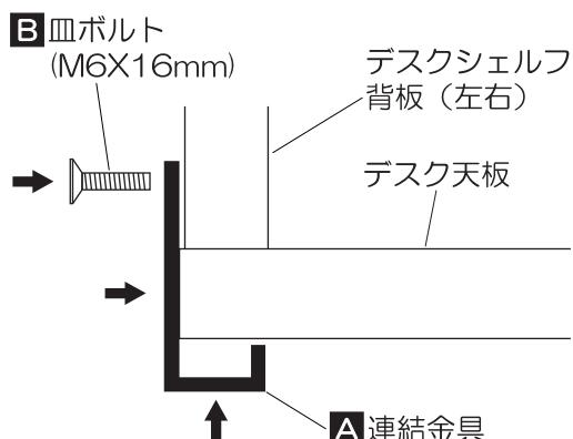
連結金具を押し当てた状態で**B**皿ボルトを取り付けてください。
