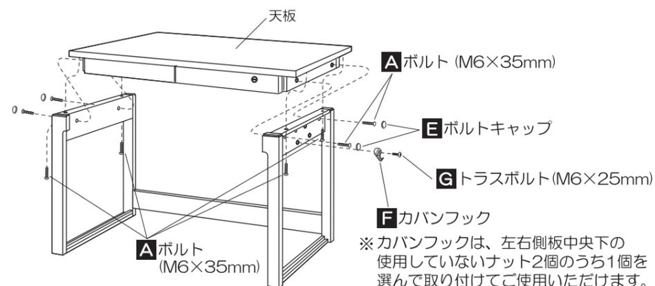
※カバンフックは、左右側板中央下の使用していないナット2個のうち1個を選んで取り付けてご使用いただけます。
