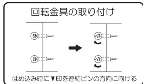
背板と側板との取付け時、背板の方向は、回転金具が後側になるよう取付けてください。
